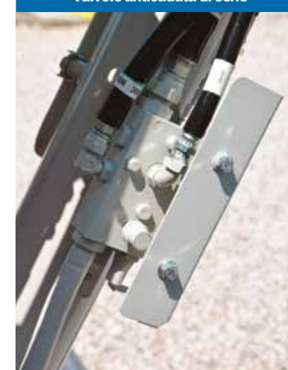
Valvole anticaduta di serie
